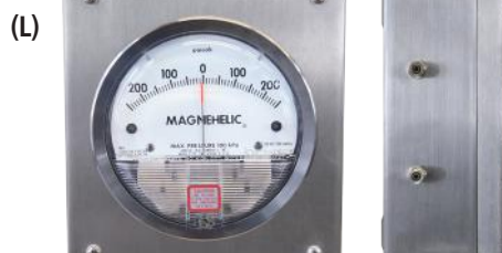
Edelstahl-Einbaugehäuse › Typ MEG-VA Maße: 140 x 140 x 65 mm Material: Edelstahl
